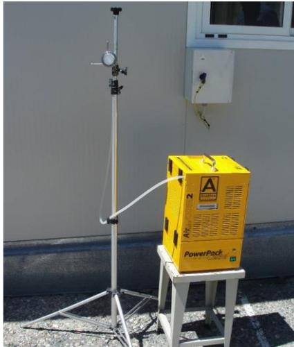
Sensore a filtro per la rilevazione delle fibre di amianto aerodisperse
